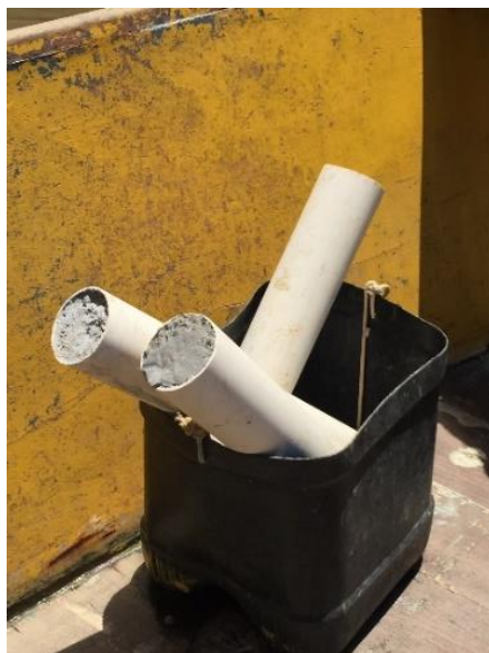
Figura 2: Descrição da forma dos Marcos geodésicos.
