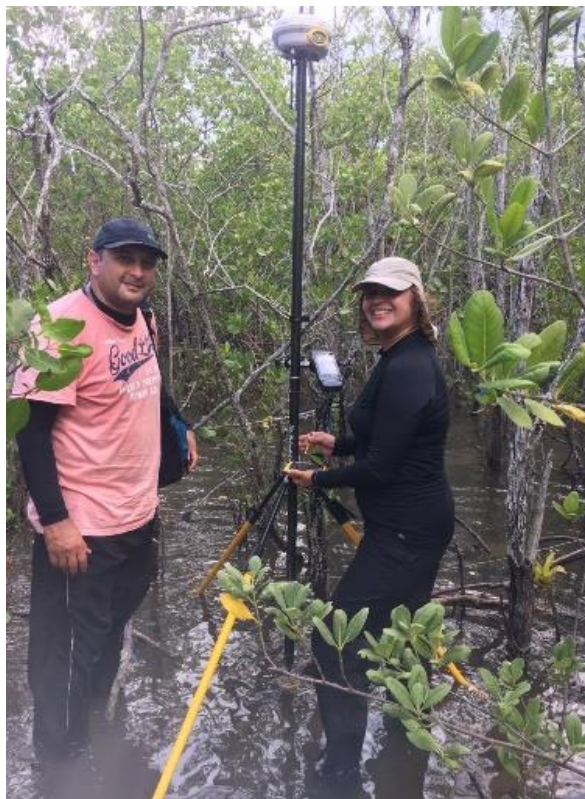
Figura 4: Medição dos marcos geodésicos com RTK no interior das parcelas.
